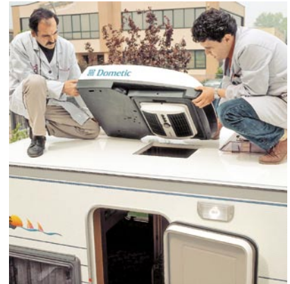
Der Einbau einer Dachklimaanlage erfolgt problemlos im vorhandenen Lukenausschnitt
